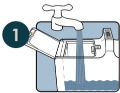
**1** Sauberes Wasser NUR bis zur Wasser-Füll-Linie auffüllen. NICHT ÜBERFÜLLEN!
