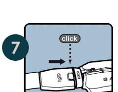
**7** Nun das kleinere Ende (*blauer Knopf*) des Verbindungsschlauches mit der Manschette verbinden.
